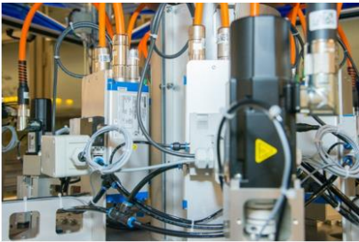
AKD-N merkezi olmayan servo regülatörler yerden tasarruf sağlayarak makinenin orta aksına yerleştirildi.
