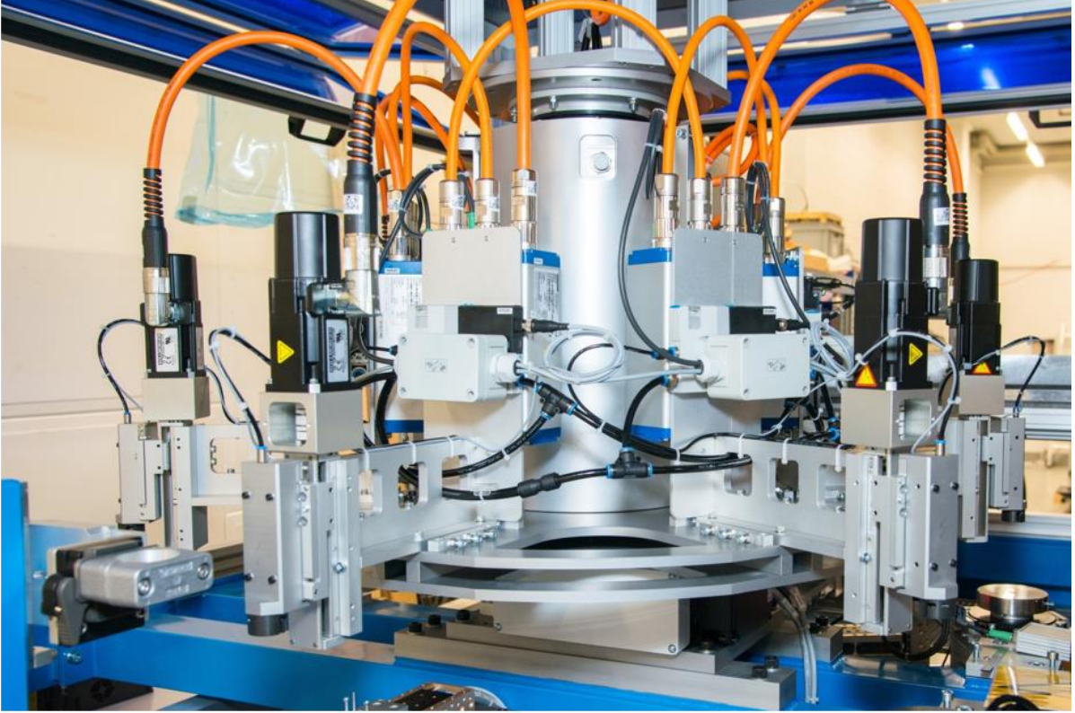
KOLLMORGEN'in AKM serisi servo motorları döner anahtarlı tabla üzerinde hareket ediyor.
